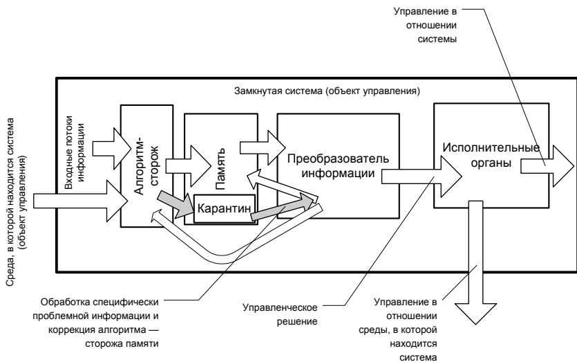
Рис. 3 АЛГОРИТМ УПРАВЛЕНИЯ С ЗАЩИТОЙ ПАМЯТИ СИСТЕМЫ ОТ НАКОПЛЕНИЯ НЕДОСТОВЕРНОЙ ИНФОРМАЦИИ
